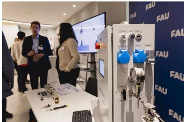
Lange Späne durch unkontrollierten Spanbruch sind immer eine große Herausforderung bei der Drehbearbeitung duktiler Werkstoffe. Jan Selzam schlägt einen innovativen Lösungsansatz von gepulster kryogener Hochdruck-Kühlung vor. Im Gegensatz zu konventionellen KSS wird der Span durch den gezielten Einsatz von kryogenen CO<sub>2</sub>-Stößen mit Frequenzen bis zu
